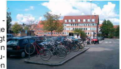
Paladspassagen. Uheldig stativtype, der kun kan betjene én hjulbredde og selv da giver begrænset støtte
